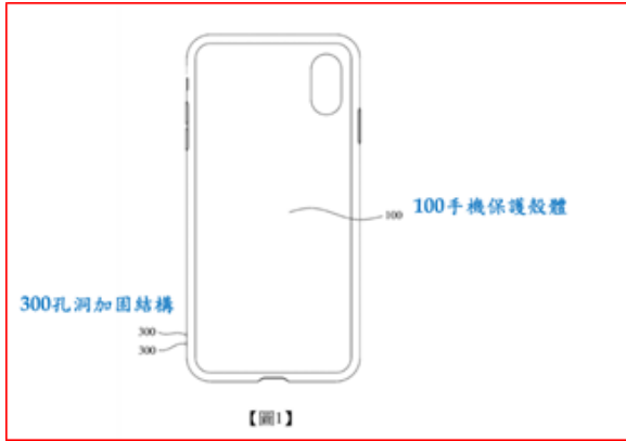
圖1係根據與本創作所描述的原理一致的一實施例，顯示示例中具有堅固的吊飾孔之手機保護殼的立體示意圖
