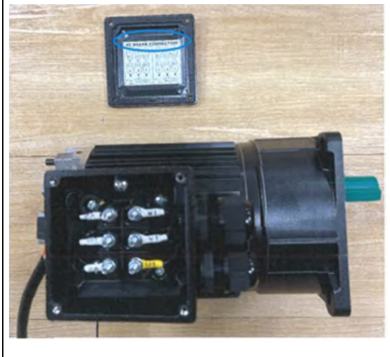
15. 系爭產品煞車器接線示意圖 (見本院卷第89頁)
