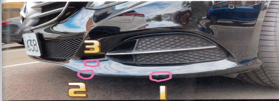
前保險桿損傷三處（保桿下緣 2個部位+上方圓形凹陷）
