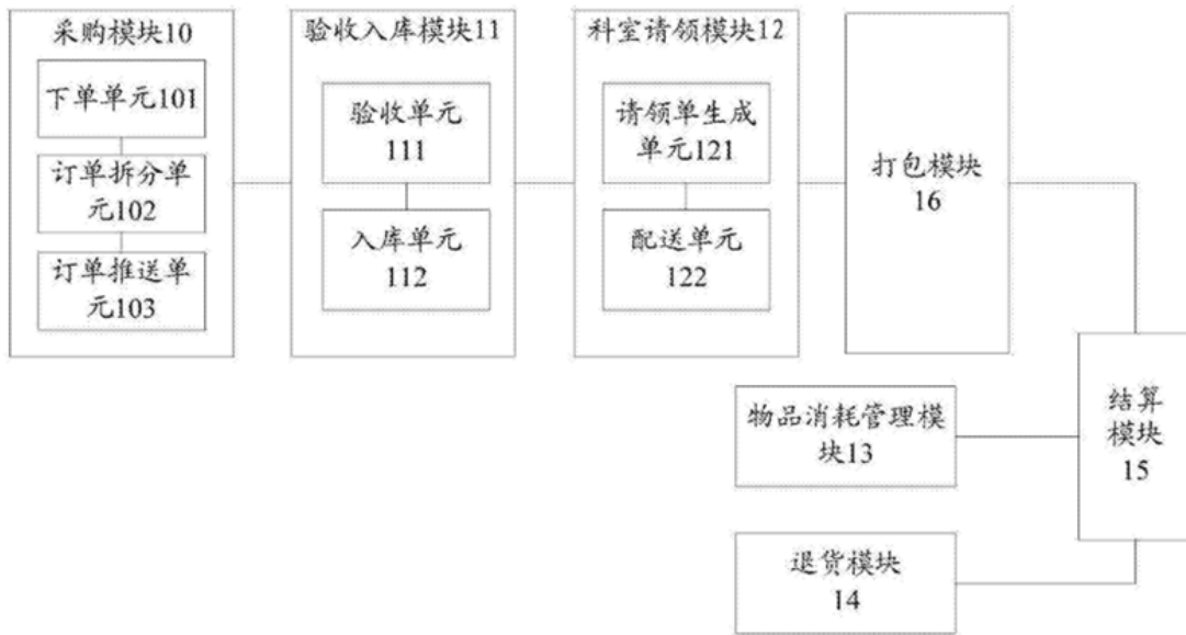
圖 2：醫院物流管理系統的結構示意圖
