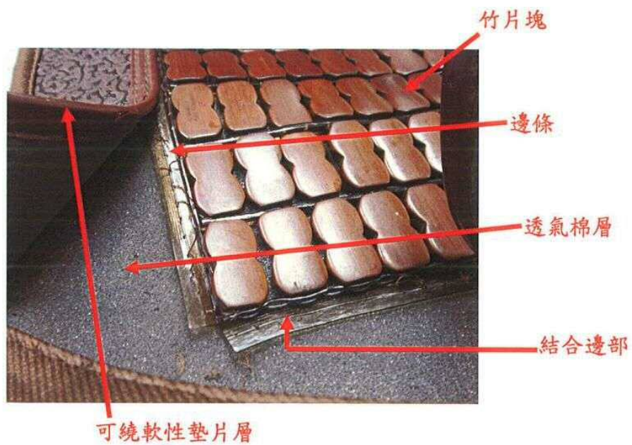
《圖四：待鑑定物透氣棉層、邊條與可繞軟性墊片層組合之示意圖》
