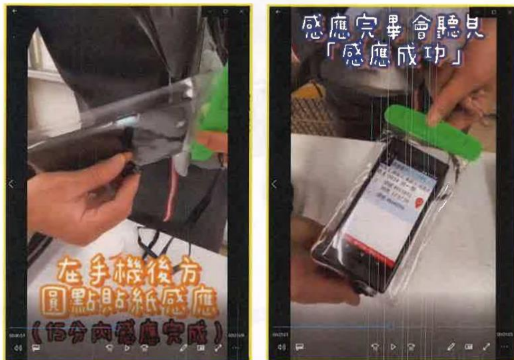
圖 4：比賽當天，賽鴿返回終點鴿舍時，第二腳環被取下，感應於鴿會事前配發之手機背面之感應區。驗證賽鴿正確性後，手機讀取第二腳環環號、鴿舍座標等資料並顯示、儲存返回時間。鴿主隨後限時內，應將該手機及第二腳環等送回鴿會等待比賽排名等結果。
